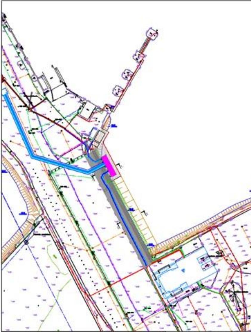
Joonis 4. Trafoalajaamale paigalduskoha rajamine ja kaldakindlustuse rekonstrueerimine (väljavõte keskkonnamoju nr KL-524475 taotlusest).
